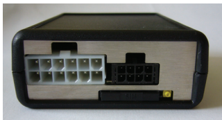
konektor K1 - hlavní konektor číslování pinů - pohled do konektoru zařízení čísle pinů nemusí souhlasit s čísly na výkřtu
